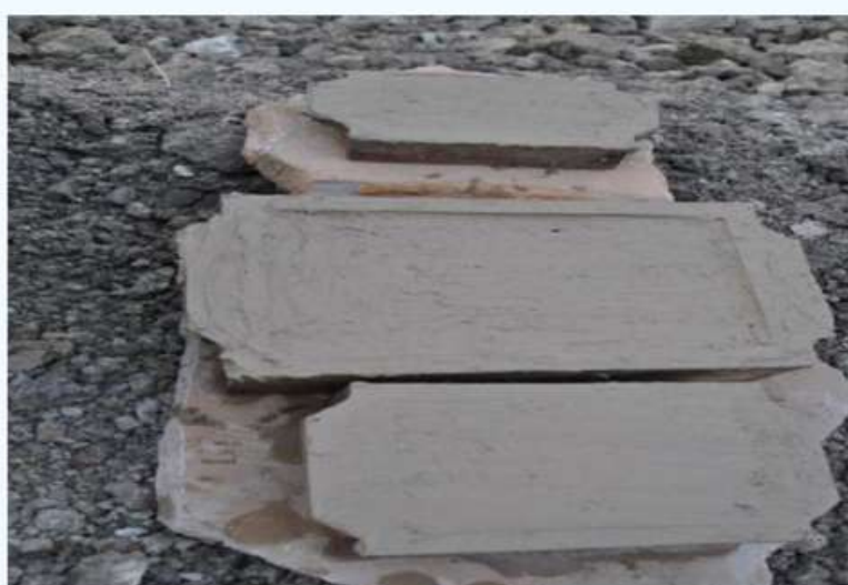
Terra + calç + palla + pinyols d'olives + aigua
